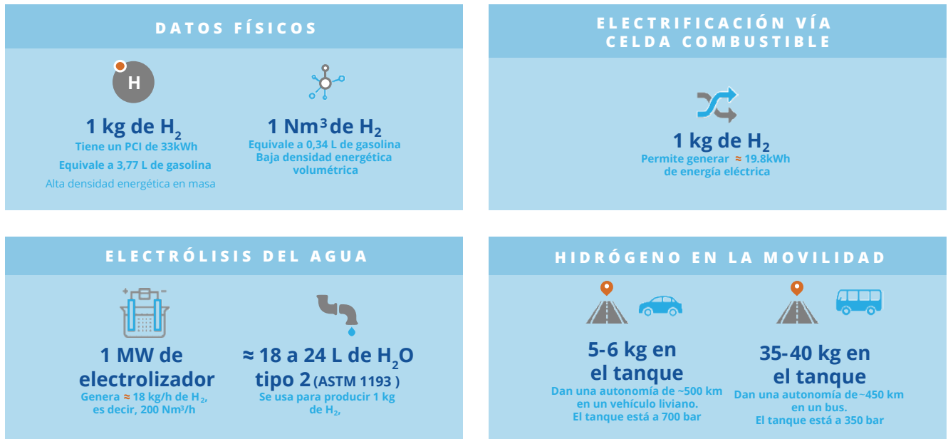
Figura 3. Datos físicos, técnicos y proporcionales del hidrógeno molecular.
